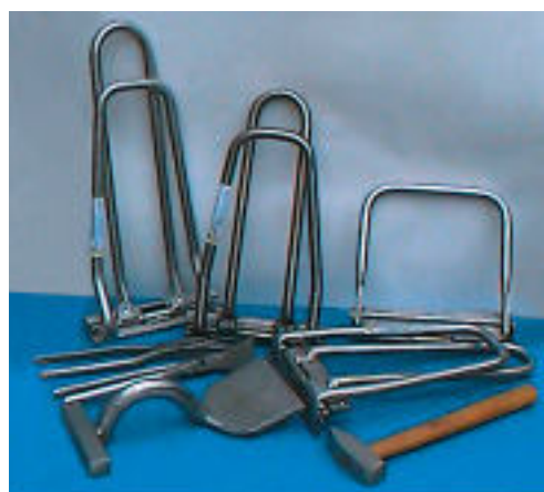
Dächer aus nichtrostendem Stahl können mit den üblichen Werkzeugen verarbeitet werden, sofern Fremdrosteinwirkung ausgeschlossen wird.
