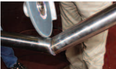
Bearbeitung der Innenseite mit einem Winkelschleifer
