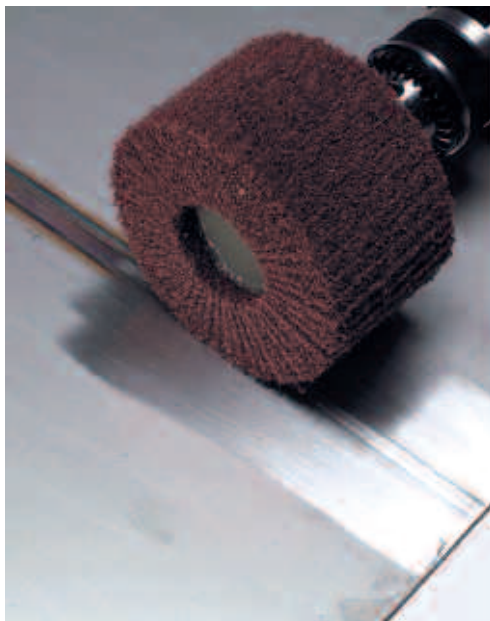
Beispiel einer Scotch-Brite™-Fächerscheibe. In der Abbildung wird eine Schweißnaht mit einer Scotch-Brite™-Scheibe behandelt, um eine Schweißnaht der übrigen Oberfläche anzupassen. Die Oberflächenbehandlung dient nicht der Einebnung der Schweißnaht; dies würde eine vorangehende Schleifbehandlung erfordern.
