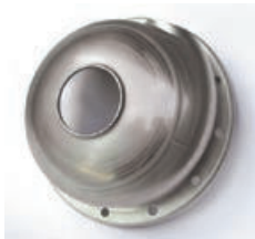
Pumpengehäuse aus einer tiefgezogenen Ronde aus nichtrostendem Stahl. Die Flüssigkeit verlässt das Gehäuse durch eine hydrogeformte Öffnung an der Oberseite.
