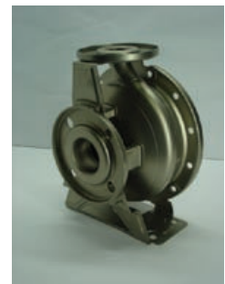
Gehäuse aus tiefgezogenem nichtrostendem Stahl
