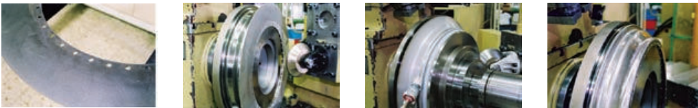
Drücken des Außenrings. Während des Umformprozesses erhöht sich die Festigkeit des nichtrostenden Stahls. Hierdurch wird die Felge robuster gegenüber Stößen.
