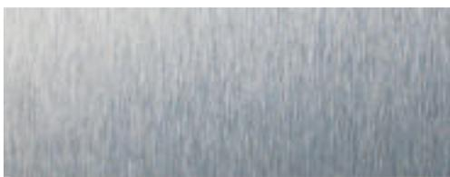
*L'aspect visuel de surfaces abrasées est fonction du matériau et de la rugosité des bandes abrasives; grain 180 (en haut) et grain 240 (en bas).*
