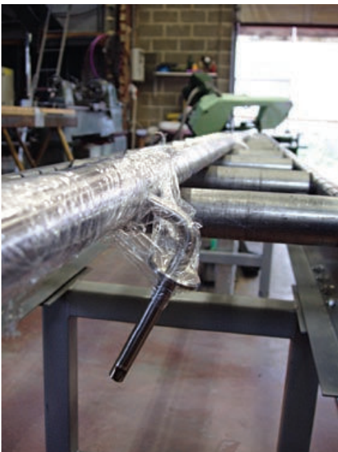
Les assemblages en atelier doivent être protégés pour éviter les endommagements et les contaminations pendant le stockage, la maintenance et le transport.
