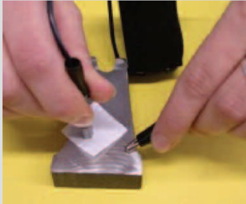
Auch benutzerfreundliche elektrochemische Testsets ermöglichen es festzustellen, ob eine Legierung molybdänhaltig ist (links) oder nicht (rechts).
