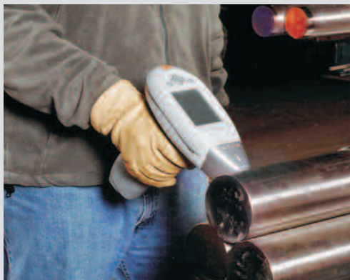
Auf tragbaren Analysergeräten lässt sich die chemische Zusammensetzung der untersuchten Legierung ablesen.
