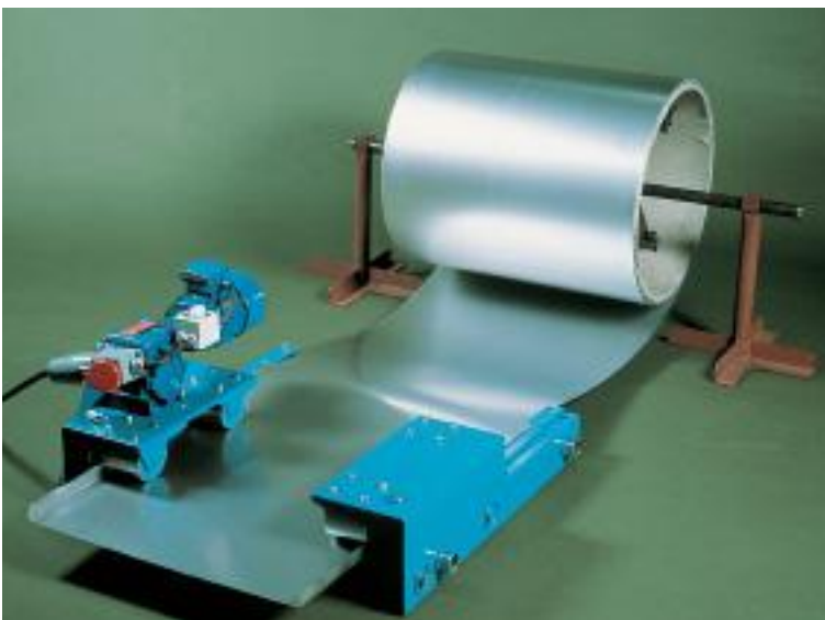
Einfache Profilierungseinrichtung (überwiegend für rollnahtgeschweißte Dächer).
