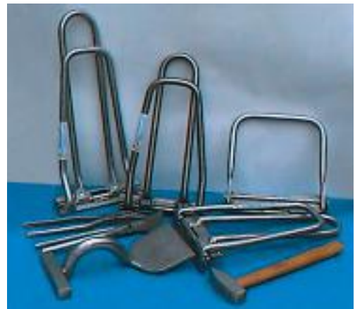
Dächer aus nichtrostendem Stahl können mit den üblichen Werkzeugen verarbeitet werden, sofern Fremdrosteinwirkung ausgeschlossen wird.
